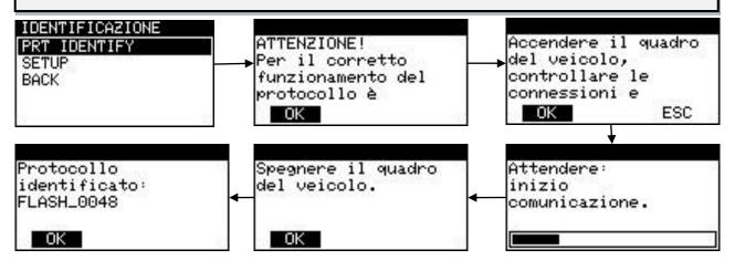
MyGenius a identifié correctement le bon protocole du véhicule. Cliquer sur OK et sélectionner à nouveau WORK, en fonction du protocole l'instrument ne pourra exécuter que l'IDentification ou toute la lecture du logiciel contenu dans le boîtier.
