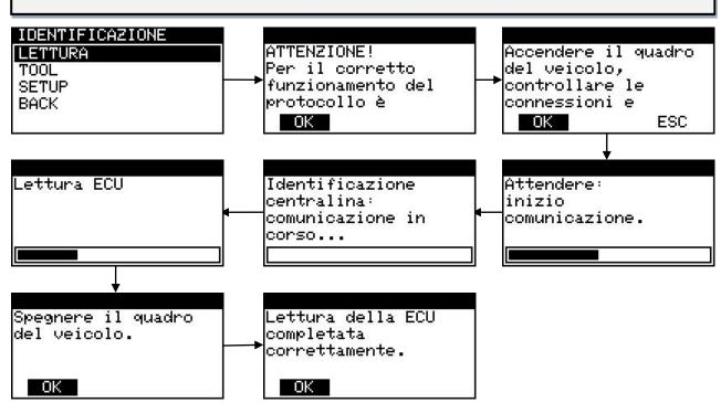
MyGenius a donc lu le boîtier correctement. Débrancher le câble OBDII du véhicule et brancher MyGenius au PC à travers le câble USB. Pour exporter la lecture, observer les instructions du chapitre *TÉLÉCHARGEMENT DU FICHIER* page 13.
